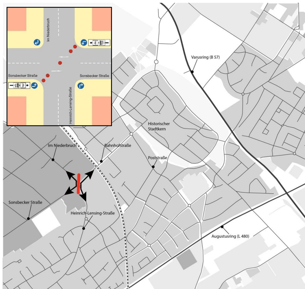
Abb. 6.-2 Maßnahme MIV 4 Diagonalsperre inklusive Prinzipskizze einer Diagonalsperre
